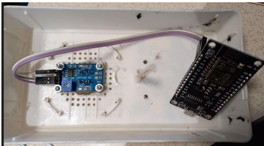
Рисунок 3.5 – Приєднання сенсора MQ-135 до корпусу
