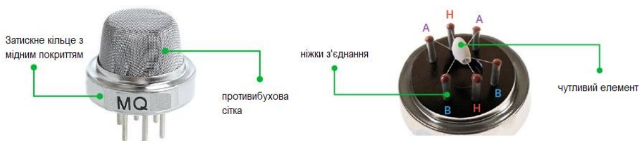
Рисунок 2.2 – Будова типового сенсора серії MQ
