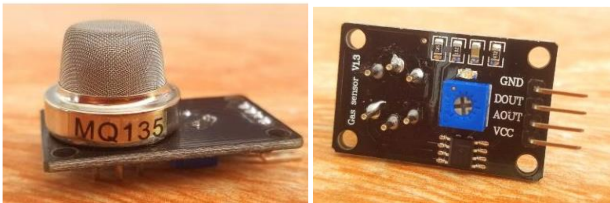
Рисунок 3.3 – Зовнішній вигляд та піни модуля сенсора MQ-135
