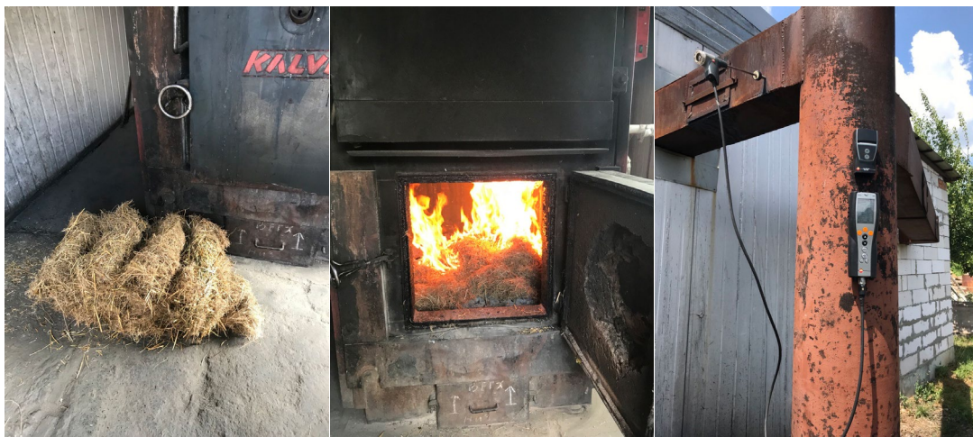
Рисунок 3.15 – Проведення випробування визначення якісного та кількісного складу викидів від спалювання ПР
