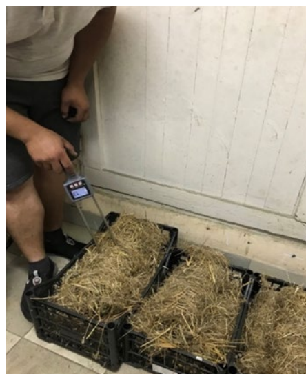
Рисунок 3.8 – Процес вимірювання вологості вологоміром ТК-100: 1 – БССК; 2 – ПР.
