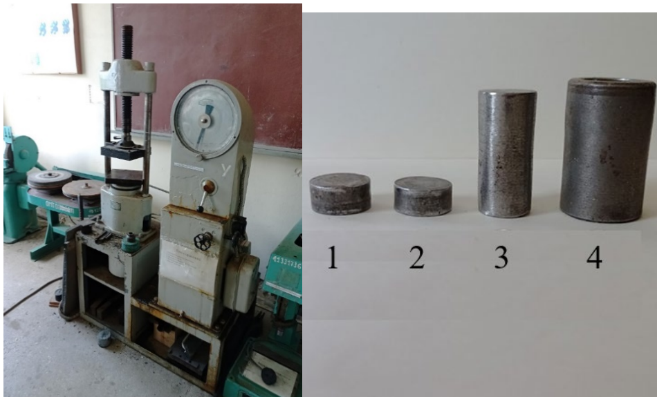
Рисунок 3.7 – Обладнання для пресування ПБ; а - прес гідравлічний 2ПГ-10; б - дослідна прес-форма для пресування ПБ: 1, 2 - верхній та нижній пуансони матриці; 3 - подовжений пуансон; 4 - матриця
