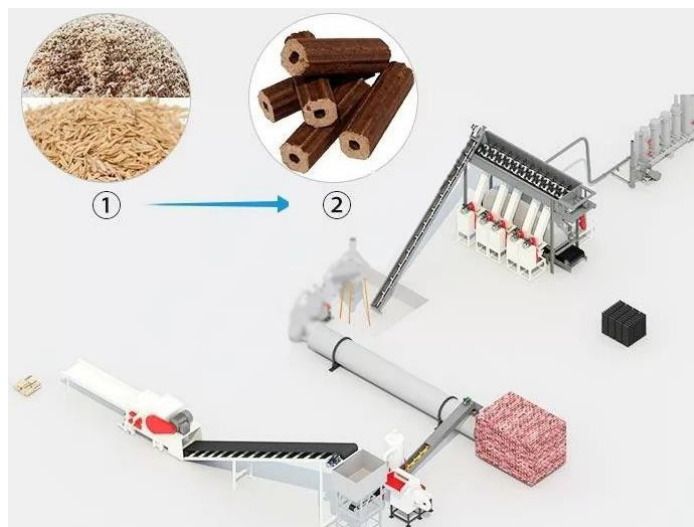
Рисунок 1.10 – Лінія виробництва ПБ типу Pini&Kay: 1 – сировина; 2 – ПБ [85]
