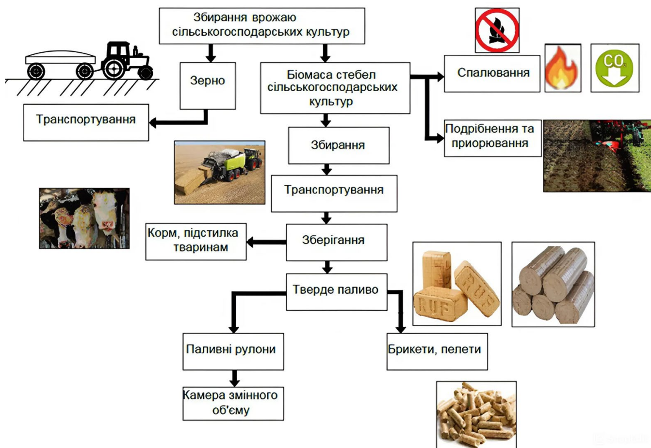
Рисунок 2.2 – Оброблення БССК з метою отримання твердих паливних матеріалів
