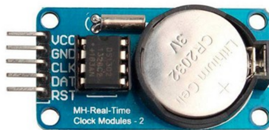
Рисунок 2.6 – Модуль DS1302 для вимірювання поточного часу [14]
