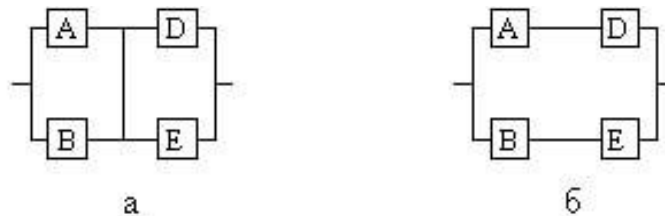
Рисунок 3 – Перетворення місткової схеми при абсолютно надійному (а) і відмовившому (б) елементі С
