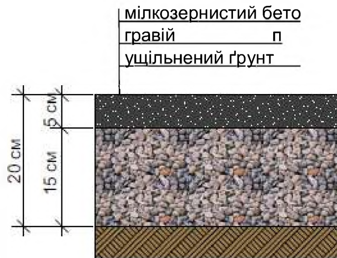
Рисунок 3.2 Конструкція дорожнього одягу пішохідних доріжок і тротуарів
