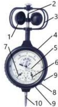
Рис. 15. Анемометр чашковий МС-13: 1 – вертушка; 2 – вал вертушки; 3 – дротяна хрестовина; 4 – лічильний механізм; 5 – центральна стрілка; 6 – права стрілка; 7 – ліва стрілка; 8 – аретир; 9 – вушко; 10 - гвинт кріплення приладу
