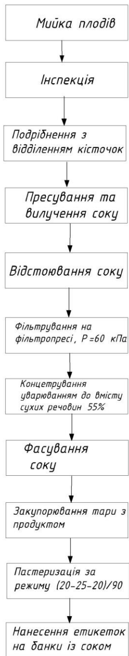
Рисунок 2.1 – Технологічна схема виготовлення концентрованого сливового соку
