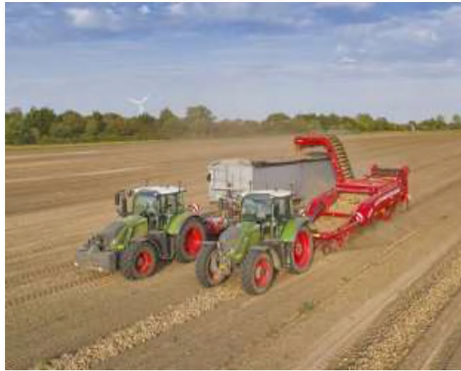
Рисунок 1.9. Підбирання комбайном попередньо викопаних копачем бульб картоплі
