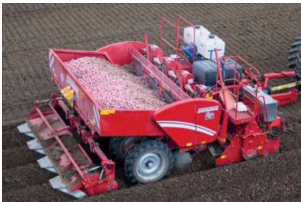
Рисунок 1.4 Комплекс для садіння картоплі
