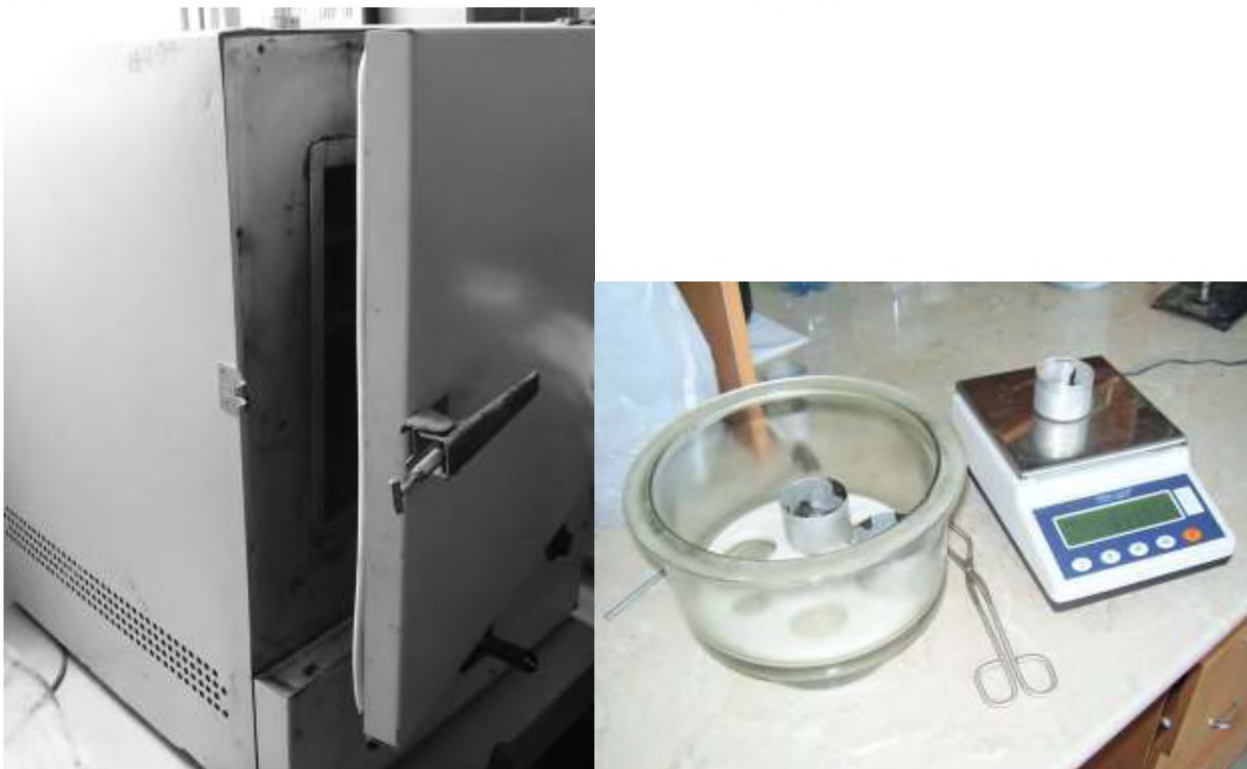
Рисунок 3.1 Обладнання, яке використовувалось у дослідженнях: сушильна електрошафа СНОЛ – 3,5.3,5.3,5/3 ИЗ; лабораторні ваги ТВЛ 0,5; ексикатор; щипці; бюкси
