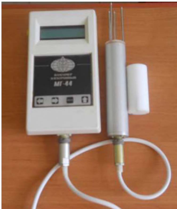
Рисунок 3.2 Електронний цифровий вологомір групи МГ-44
