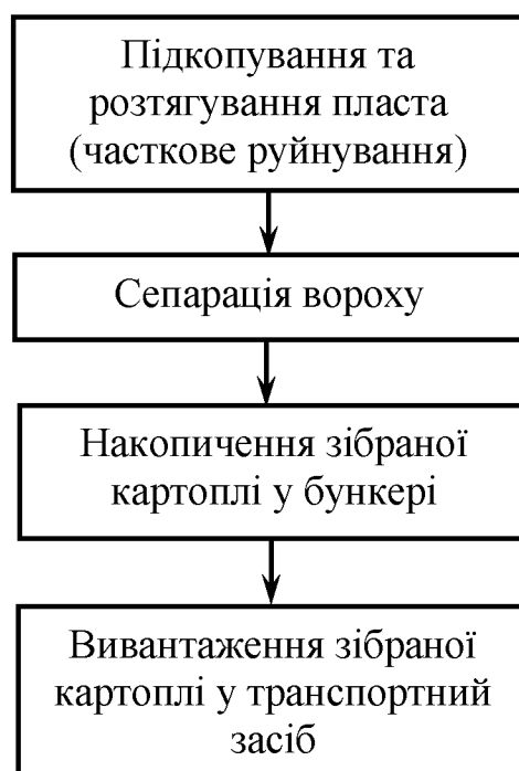
Рисунок 2.1 Структурна схема роботи модернізованого картоплекопача
