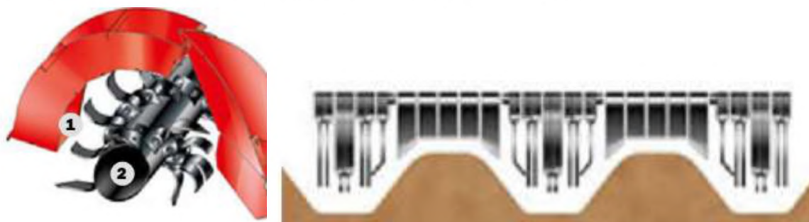
Рисунок 1.11 Будова пристрою для видалення бадилля (а) та схема розташування бичів (б)
