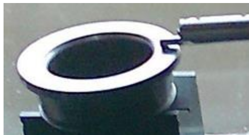
Рисунок 3.11 – Дослідження шорсткості кільця підшипника
