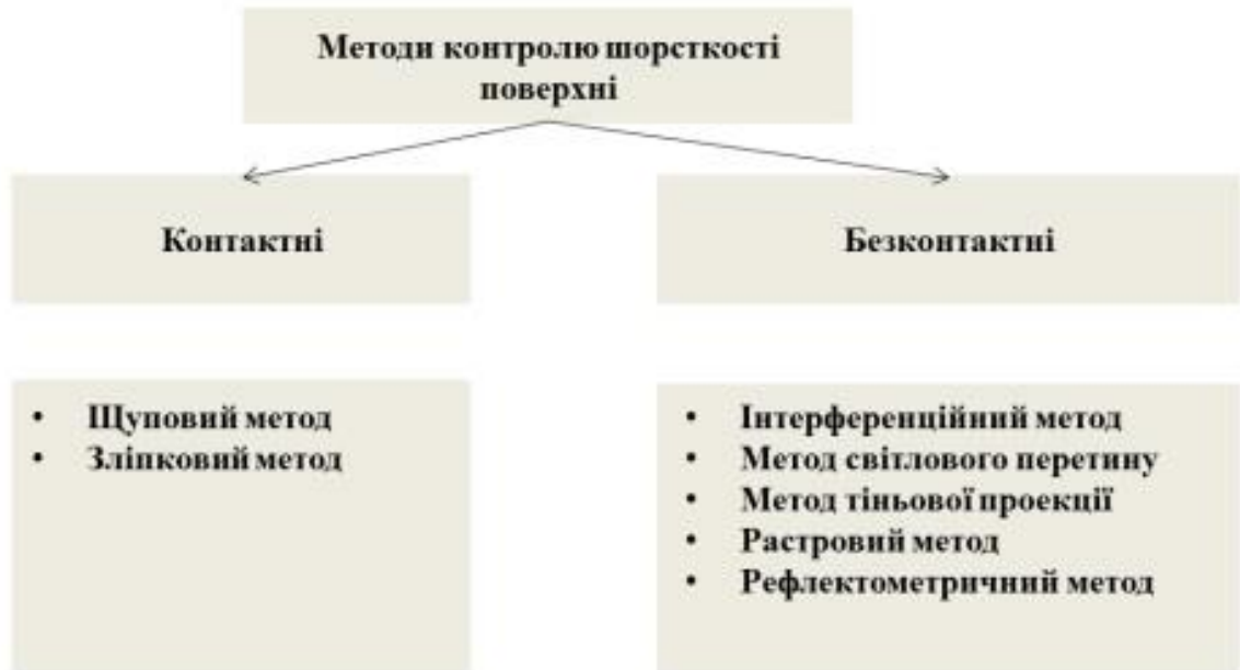
Рисунок 1.1 – Методи визначення шорсткості поверхонь деталей [3]
