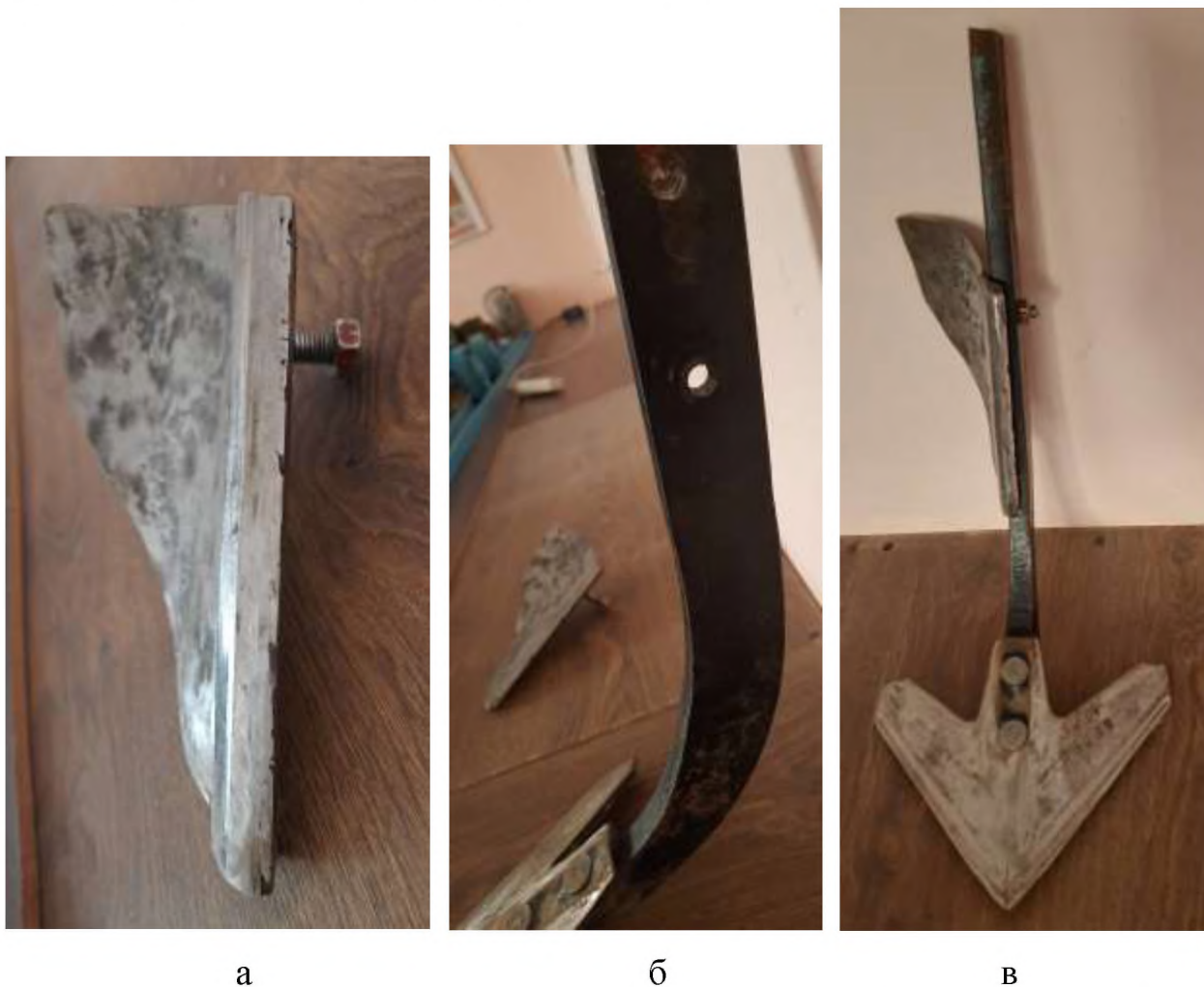
Рисунок 3.3. Фото експериментального робочого органу: а – полиця із кріпленням; б – стійка з отвором під кріплення полиці; в – збірка
