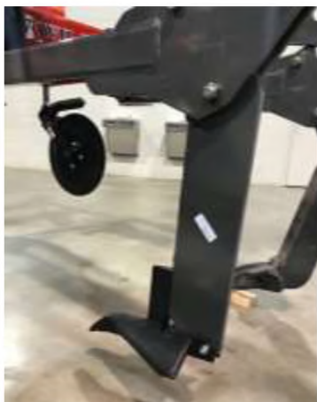
Рисунок 1.13 Робочі органи глибокорозпушувачів фірми Wil-Rich: а – мінімальне зміщення ґрунту, б – параболічний
