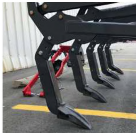
Рисунок 1.13 Робочі органи глибокорозпушувачів фірми Wil-Rich: а – мінімальне зміщення ґрунту, б – параболічний
