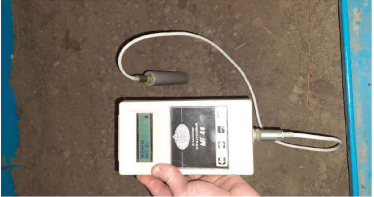
Рисунок 3.6 Процес визначення вологості ґрунту у ґрунтовому каналі
