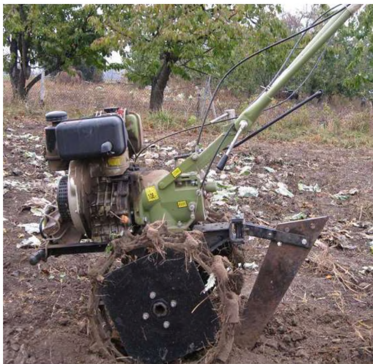
Рисунок 1.17 - Фото Мотоблоку ZIRKA IZ 105 із глибокорозпушуючим ножом
