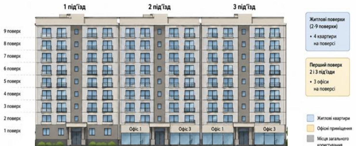
Рисунок 2.1 – План багатоквартирного будинку з вбудованими комерційними приміщеннями
