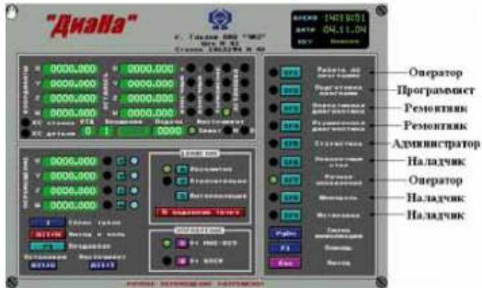
Рисунок 2.4 – Доступ до функцій і інформаційних ресурсів в системі ЧПУ «Диана-0 для окремих аспектів процесу експлуатації обмежений
