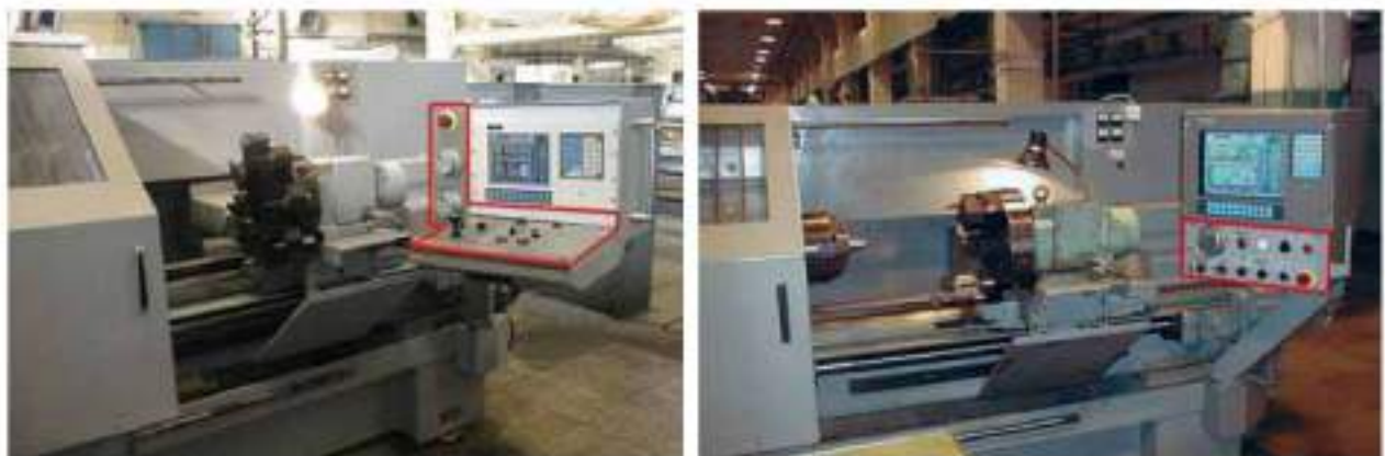
Рисунок 2.3 – Приклад неефективної модернізації: через неузгоджених дій різних аспектів експлуатації однакові верстати мають різні органи управління
