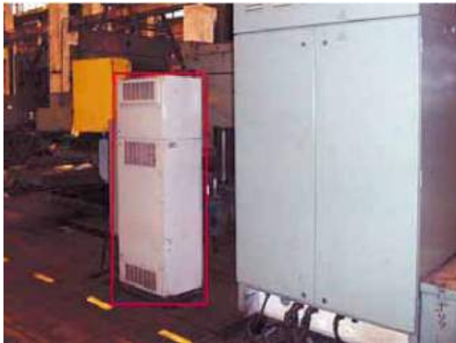
Рисунок 2.2 – Приклад неефективної модернізації: із-за неузгоджених дій різних аспектів експлуатації довелося залишити значну частину старої системи ЧПУ
