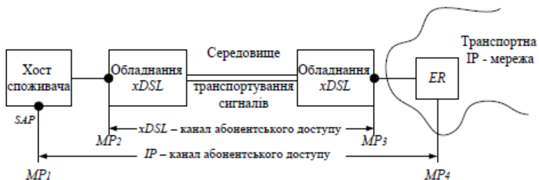
Рисунок 4.6 – Схема вимірювань параметрів послуги абонентського доступу до транспортної IP-мережі з використанням обладнання xDSL
