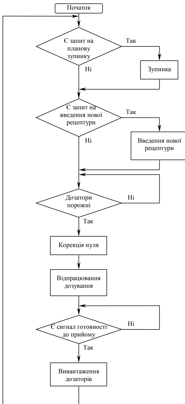
Рисунок 7.1 – Блок-схема загального алгоритму керування
