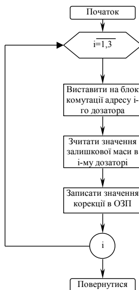
Рисунок 7.3 – Блок-схема алгоритму корекції нуля вагових дозаторів
