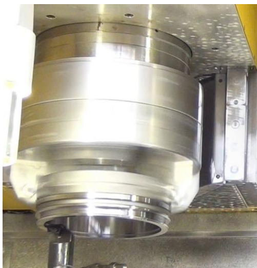
Рисунок 4.2 Точне перенесення деталі в DVT 450 від MAG Hessapp між шпинделями
