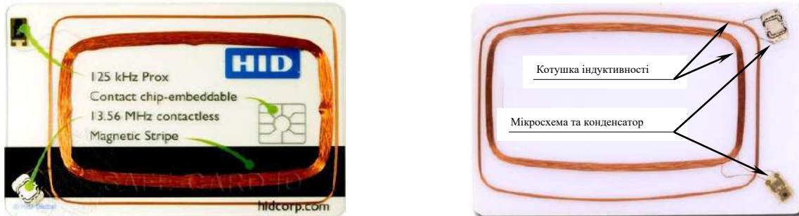
Рисунок 3.8 – Будова карти радіочастотної ідентифікації [110]
