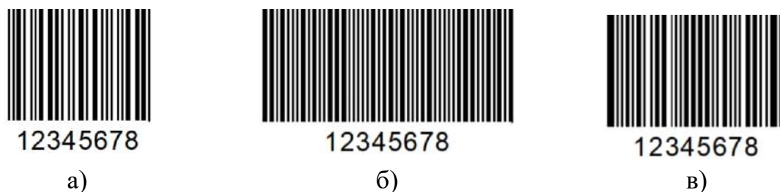
Рисунок 3.21 – Приклади штрихового коду сімейства 2 of 5 [110] а) – Interleaved; б) – Industrial та в) – Matrix
