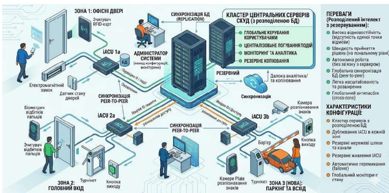
Рисунок 7.2 – Топологія розподіленого інтелекту з резервуванням
