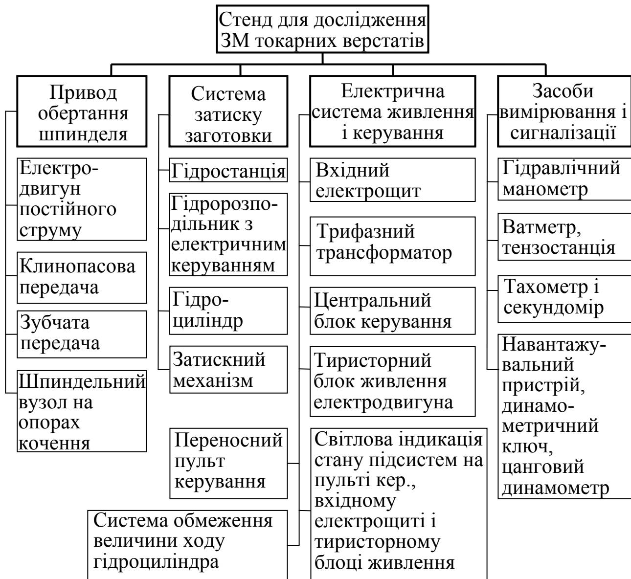
Рис. 5.2. Структура створеного науково-дослідного стенда
