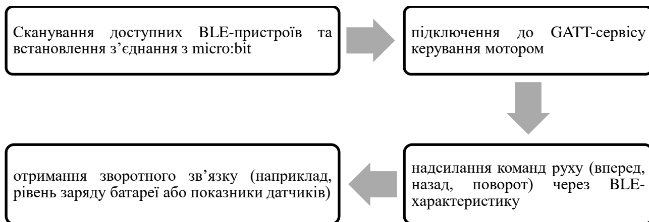
Рисунок 2.1 – Алгоритм роботи BLE-з'єднання для керування роботом
