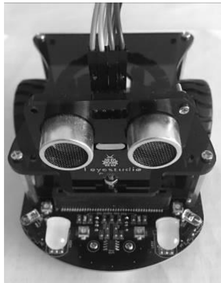
Рисунок 3.12 – Зібраний мобільний робот на базі комплекту Micro:bit Mini Smart Robot Car Kit V2
