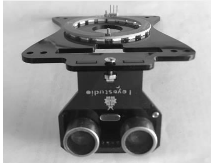
Рисунок 3.9 – Верхній щит у зібраному вигляді після монтажу електронних компонентів
