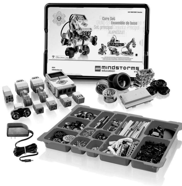
Рисунок 1.2 – Базовий набір LEGO MINDSTORMS Education EV3 [4]
