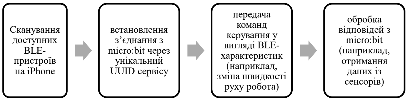
Рисунок 1.6 – Взаємодія робототехнічної системи на основі micro:bit з iPhone [10]
