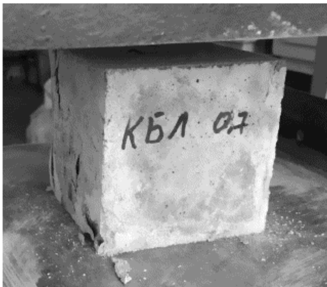
Рисунок. 6.5. Руйнування бетонних кубів при стиску
