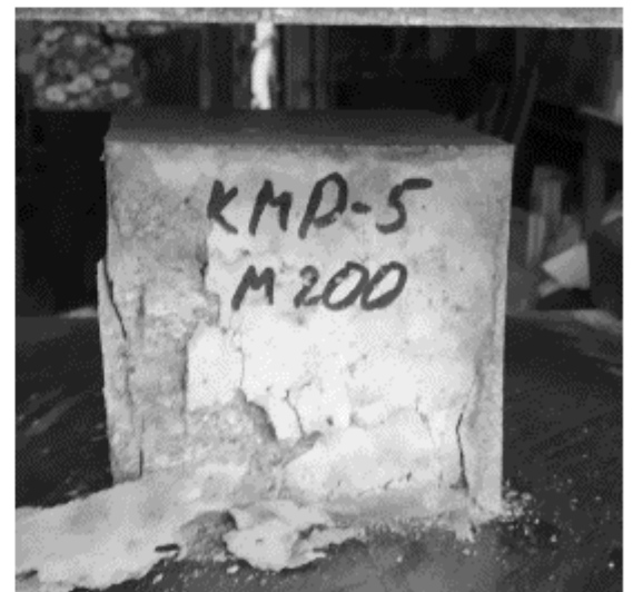
Рисунок. 6.5. Руйнування бетонних кубів при стиску
