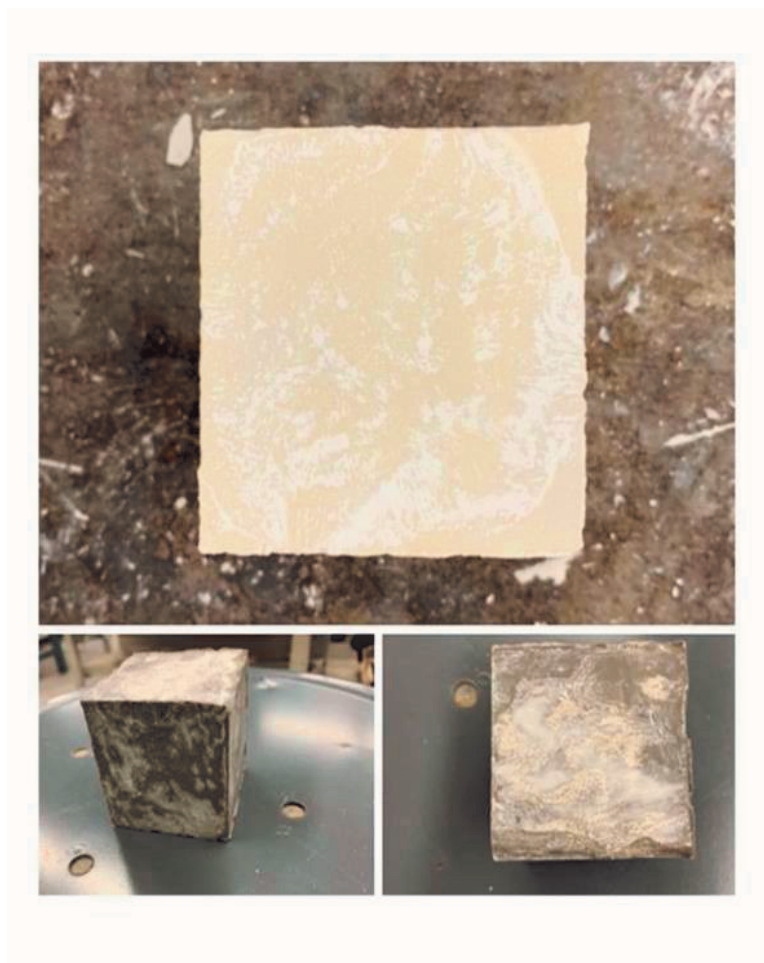
Рисунок 3.4 – Геополімери на основі метакаоліну зі складом «0,9-1,0-2,6-12», виготовлені за допомогою(вгорі) MMax і (внизу) WM, через 7 днів.
