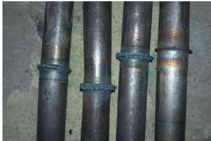
Рисунок 2.1 – Зварні заготовки зі сталі 18Г2С
