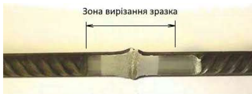
Рисунок 2.4 – Відрізання зразків для аналізу структури з'єднання
