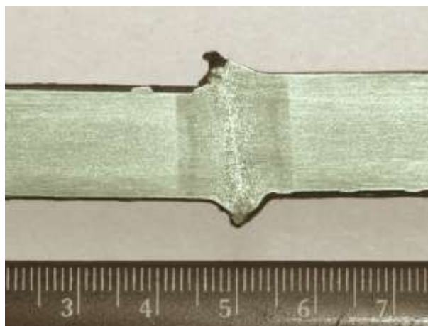
Рисунок 3.3 – Зони термічного впливу для режиму зварювання оплавленням
