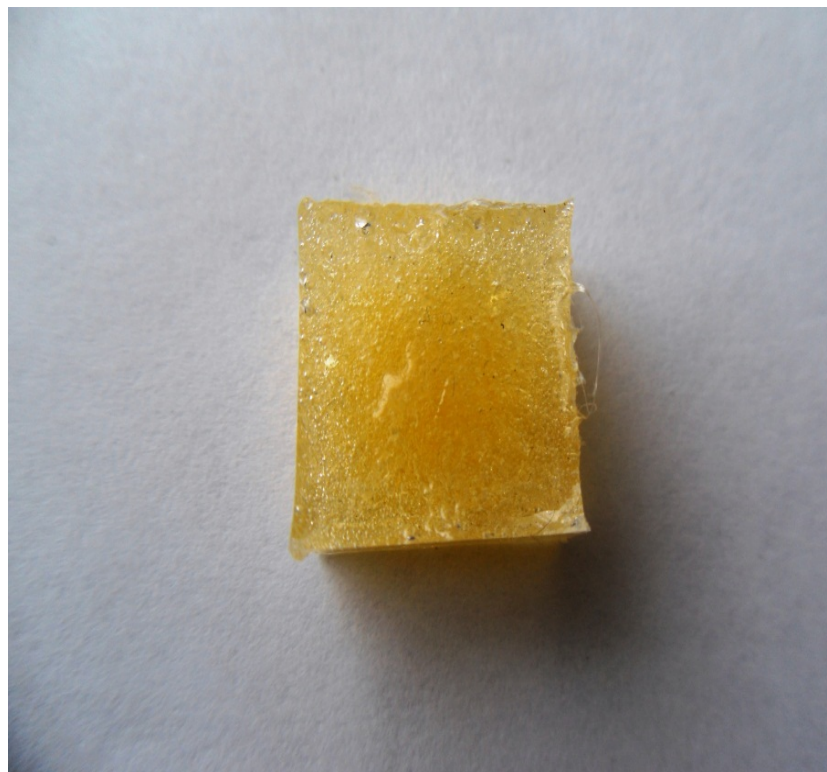
Рисунок 3.2 – Загальний вигляд зразка епоксиполімеру структурованого нагріванням до температури 373 К після попередньої витримки за кімнатної температури протягом 2 годин
