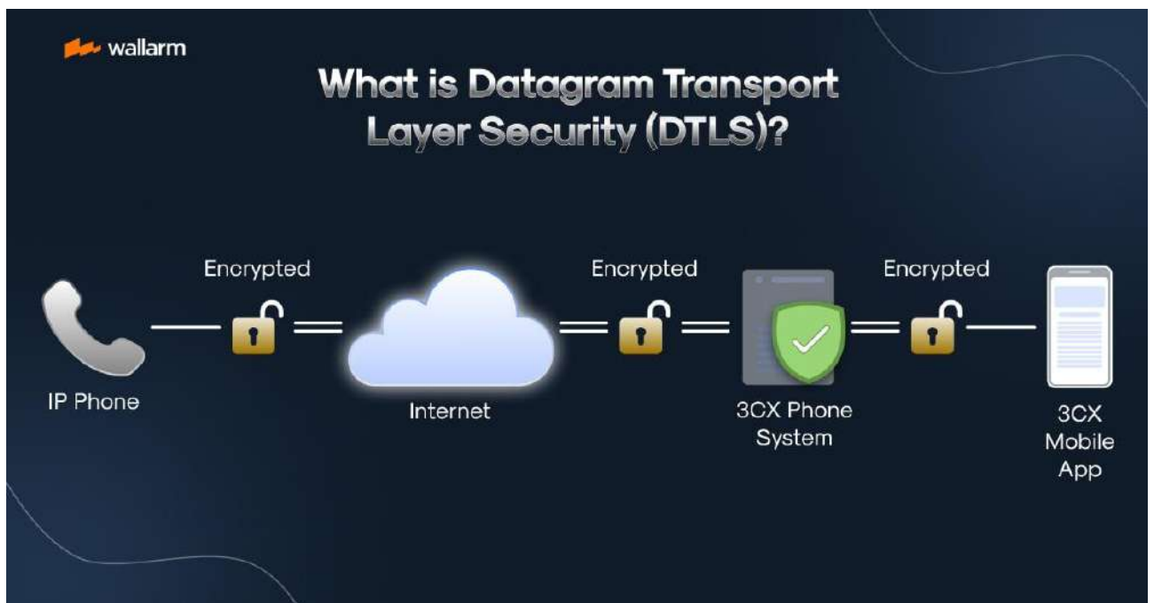
Рисунок 2.5 – Схема функціонування протоколу DTLS [17]
