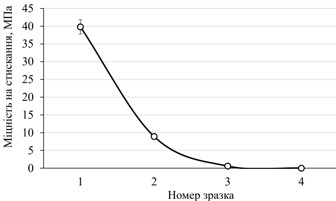
Рисунок 3.1 – Залежність міцності на стискання біокомпозитів від вмісту води: 1 – без води, 2 – 1 мл, 3 – 2 мл, 4 – 3 мл
