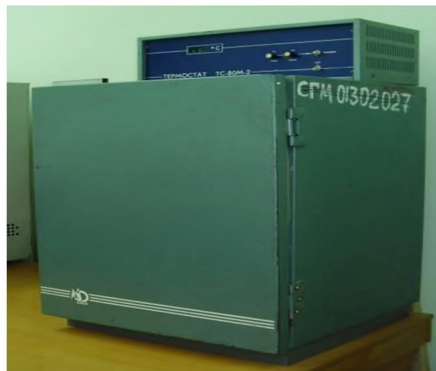
Рисунок 3.1- Загальний вигляд сушильної електрошафи СНОЛ 3.5
