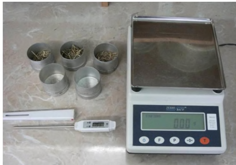
Рисунок 3.2 - Загальний вигляд електронної ваги ТВЛ-0.5, та термометра-щупа.
