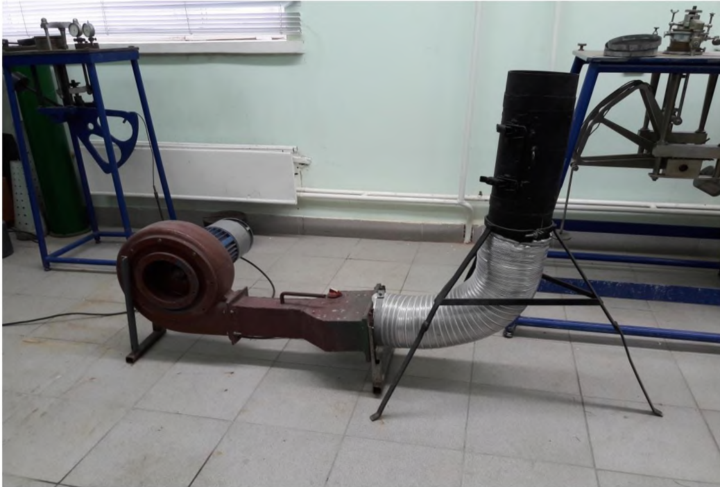
Рисунок 3.4 - Лабораторна установка для дослідження процесу сушіння насіння ріпаку
