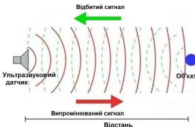
Рисунок 1.3 – Принцип дії ультразвукового датчику руху [4]
