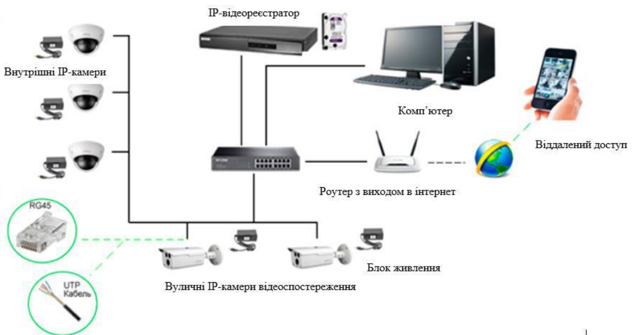
Рисунок 1.7 – Компоненти та порядок з'єднань компонентів IP-систем відеоспостереження [12]
