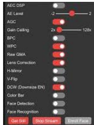
Рисунок 3.14 – Налаштування інтерфейсу розпізнавання та реєстрації обличчя в системі ESP32-CAM
