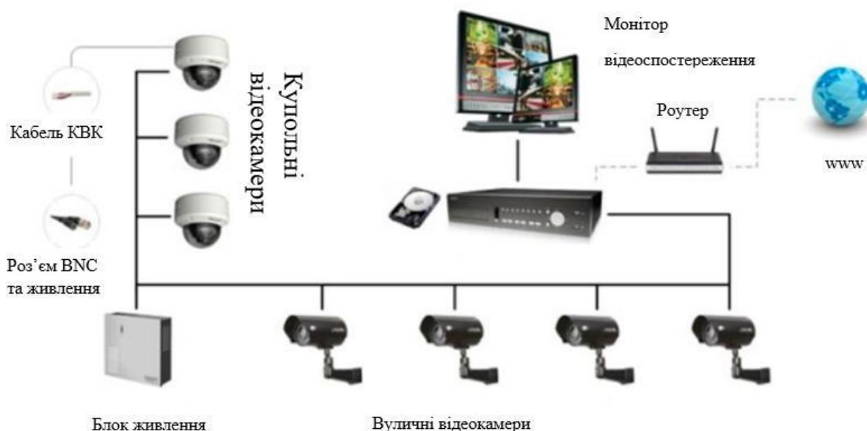
Рисунок 1.5 – Схема побудови типової аналогової системи відеоспостереження [10]
