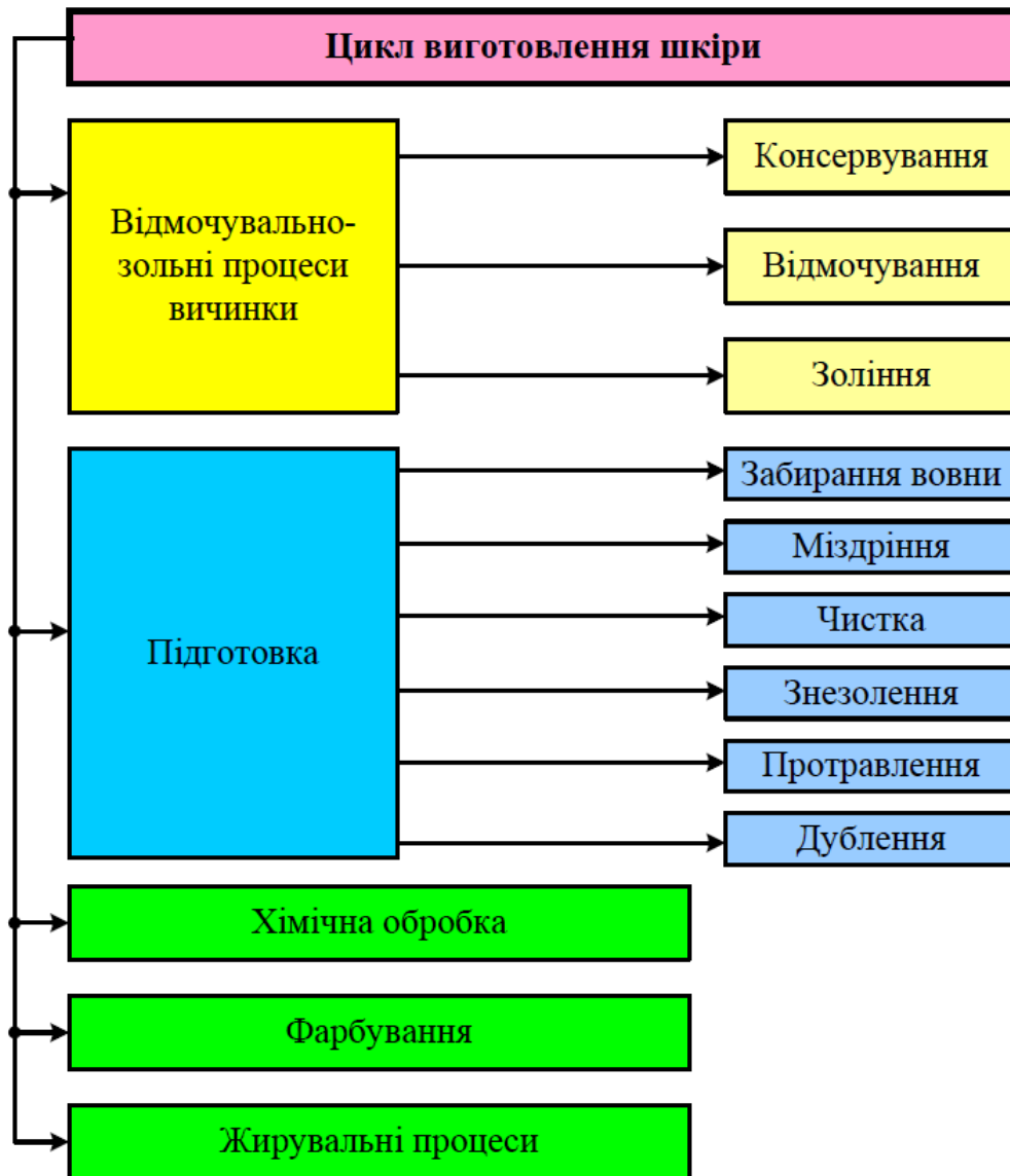
Рисунок 1.1 – Основні стадії циклу виготовлення шкіри
