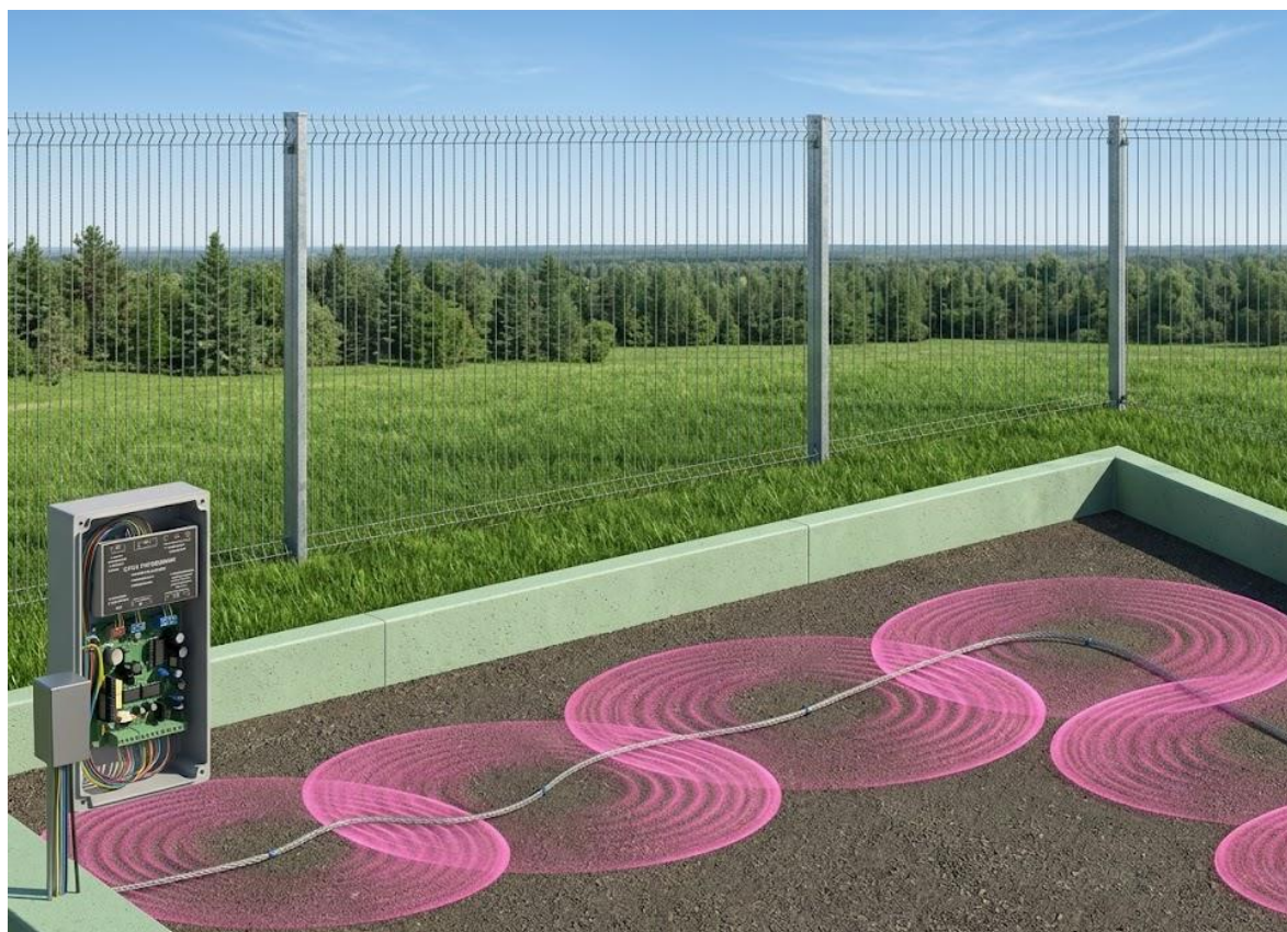
Рисунок 1.6 – Зона виявлення сейсмічного сповіщувача [16]
