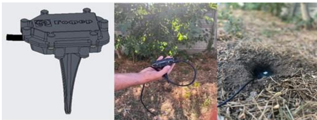
Рисунок 2.3 – Сейсмічна система охорони ARCTIUM [25]
