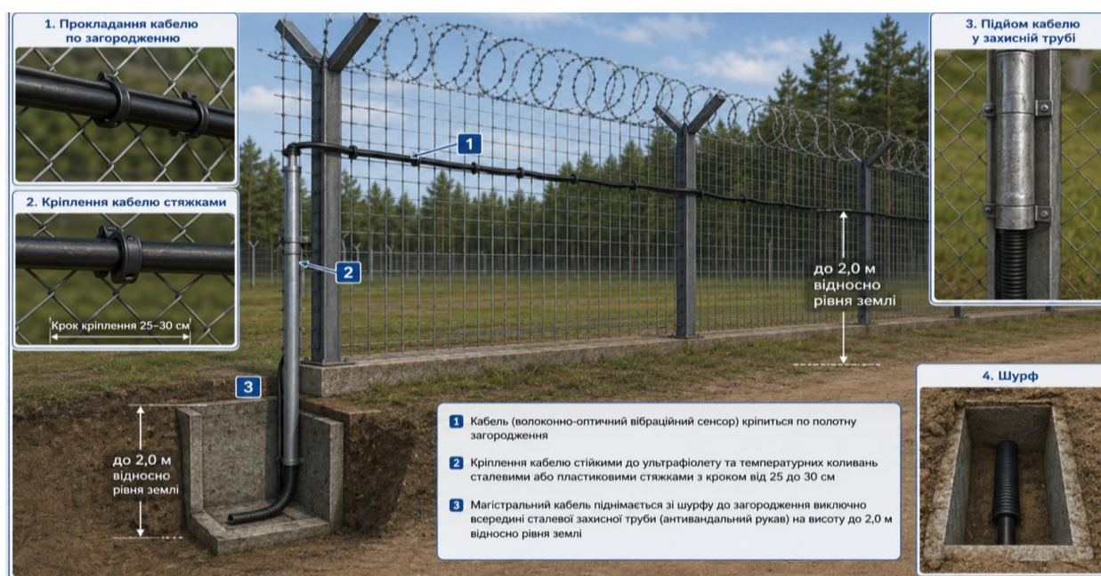
Рисунок 3.2 – Монтаж розподільчої мережі та лінійних давачів
