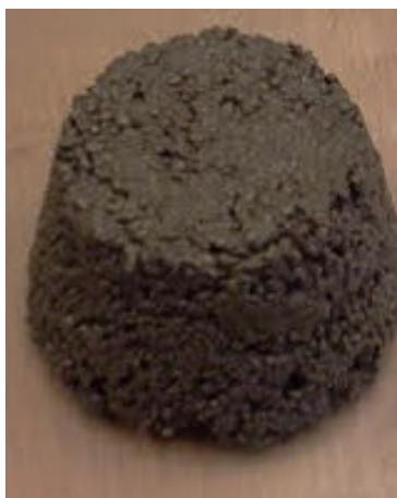
Рисунок 2.9 – Випробування на плинність за допомогою конуса Хегермана
