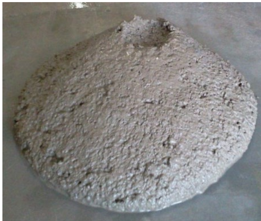
Рисунок 3.20 – Технологічність суміші після 60 хвилин змішування при використанні рідини з концентрацією 160 мл/л
