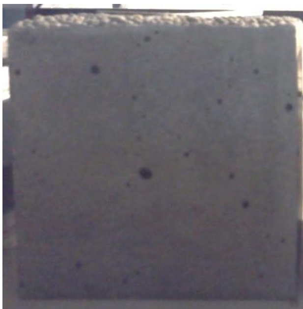
Рисунок 3.16 – Зразок із попередньо просоченим LWA має кілька відкритих порожнин
