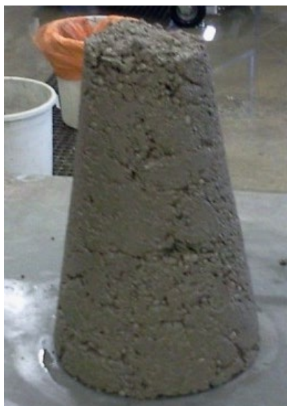
Рисунок 2.8 – Випробування на осідання за допомогою конуса Абрамса
