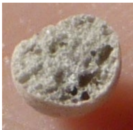
Рисунок 2.4 – Внутрішня поверхня LWA товщиною 2...4 мм
