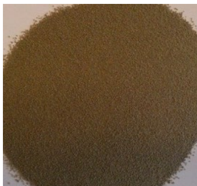
Рисунок 2.2 – Легкий заповнювач LWAз фракцією частинок 0,25...0,5 мм
