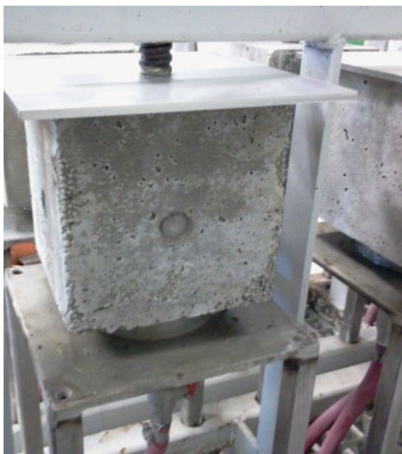
Рисунок 2.13 – Випробування після проникнення води під тиском
