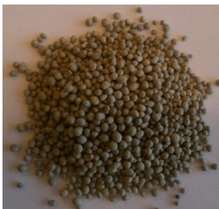
Рисунок 2.3 – Легкий заповнювач LWAз фракцією частинок 2...4 мм
