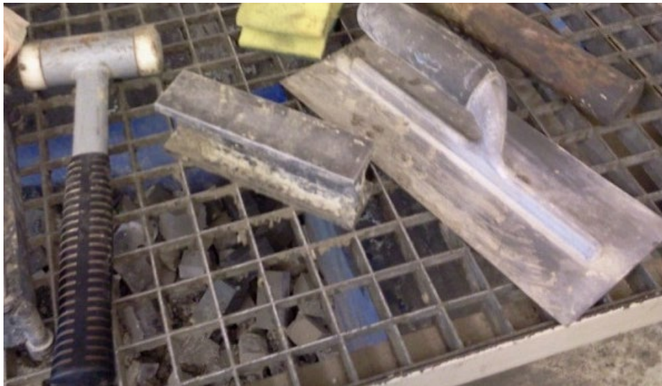
Рисунок 2.6 – Пресувальні стрижні, молоток та інструмент для оздоблення
