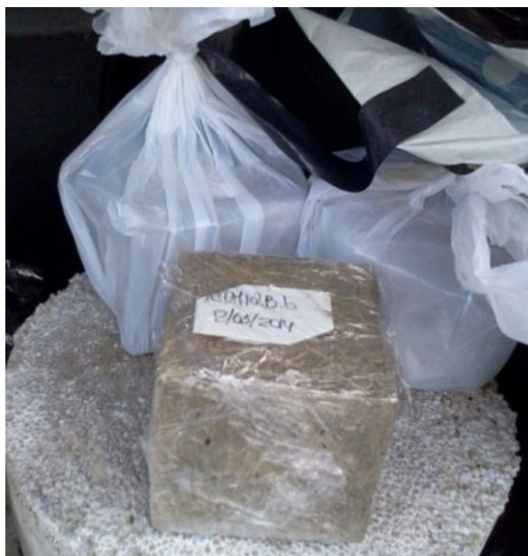
Рисунок 2.12 – Зразки загорнуті в пластикову фольгу та поміщені в пластиковий пакет
