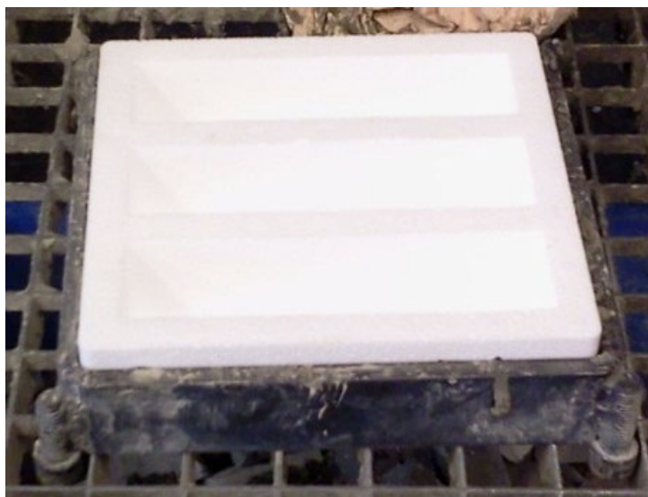
Рисунок 2.5 – Сталева рама навколо пінополістирольної форми
