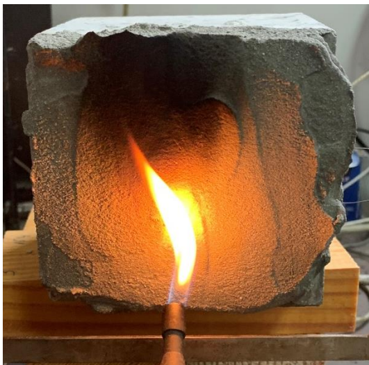
Рис. 3 – Визначення ефективності вогнезахисту бетону
