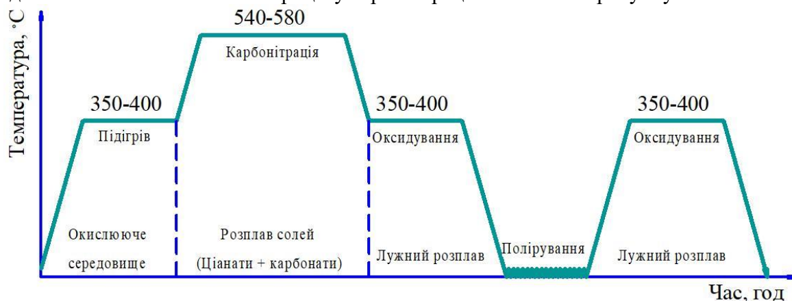
Рис. 1 – Технологічна схема процесу карбонітрації
