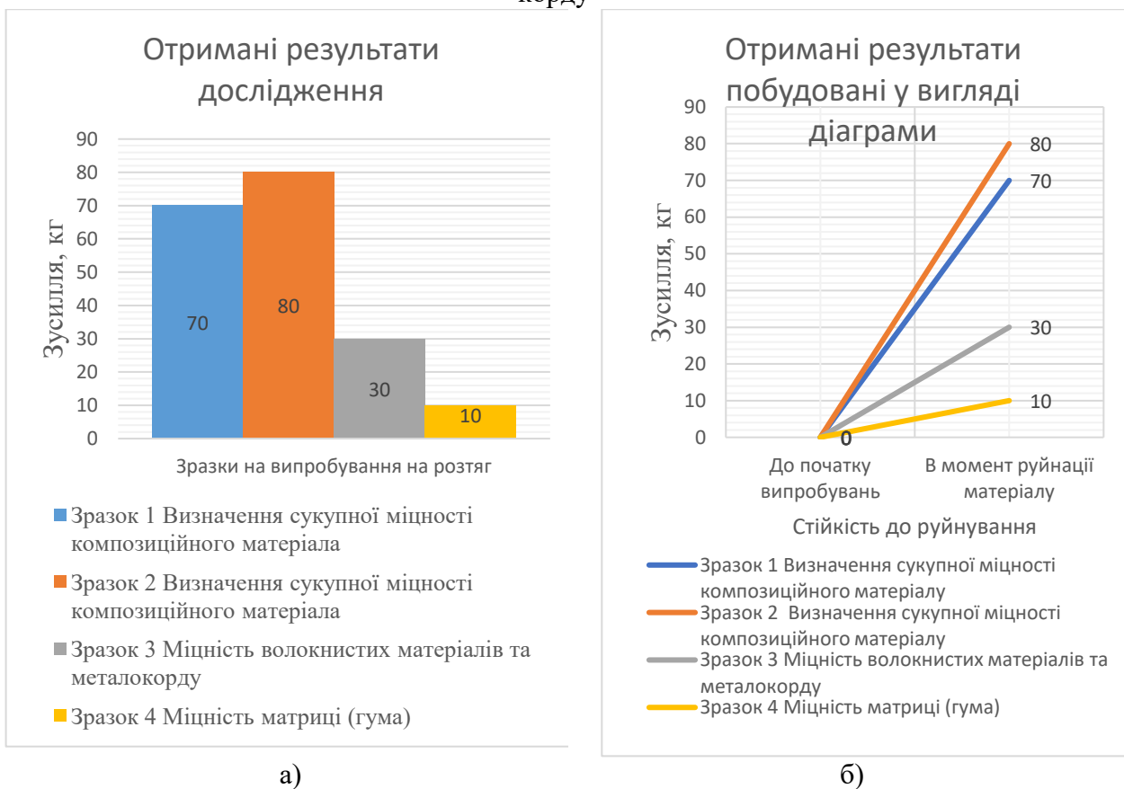
Рис. 4 – а)отримані результати дослідження для декількох дослідних зразків зразок 1,2 – визначення сукупної міцності композиційного матеріалу; зразок 3–міцність волокнистих матеріалів та металокорду; 4 – міцність матриці (гума). б)отримані результати дослідження побудовані у вигляді діаграми від початку випробувань до моменту руйнації
