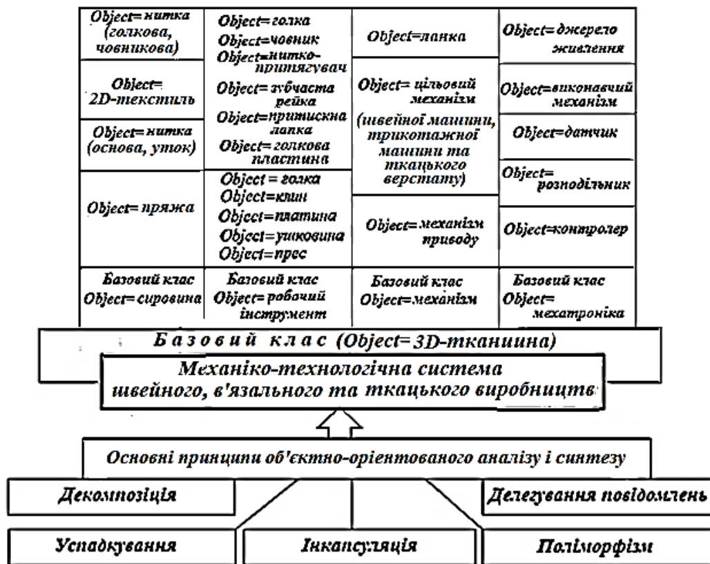
Рис. 1 – Схема узагальненої топології об'єктно-орієнтованого проектування механіко-технологічних систем 3D-тканин швейного, в'язального, ткацького та плетельного промислових виробництв
