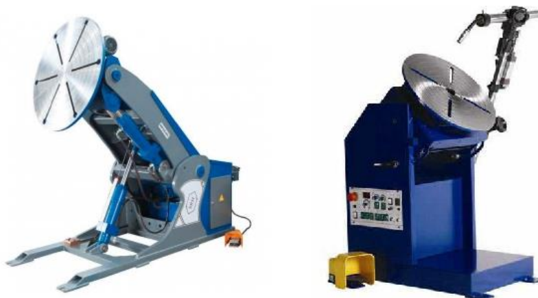
Рис.2 – Приклади універсально поворотних зварювальних пристроїв
