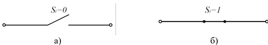
Рисунок 2.3 – Значення функцій перемикачів S при різних станах ключів
