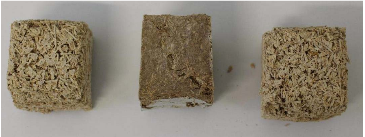
Рисунок 2.6 – Кубічні зразки деревного геополімербетону.
