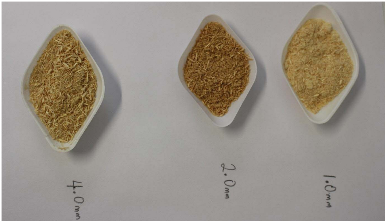
Рисунок 2.1 – Лігноцелюлозні матеріали після подрібнення на фракції розміром 1 мм, 2 мм та 4 мм.
