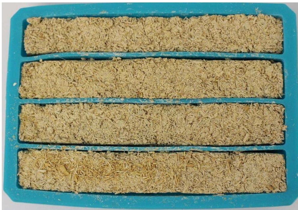
Рисунок 2.4. – Пластикові форми для лиття деревних геополімерів.
