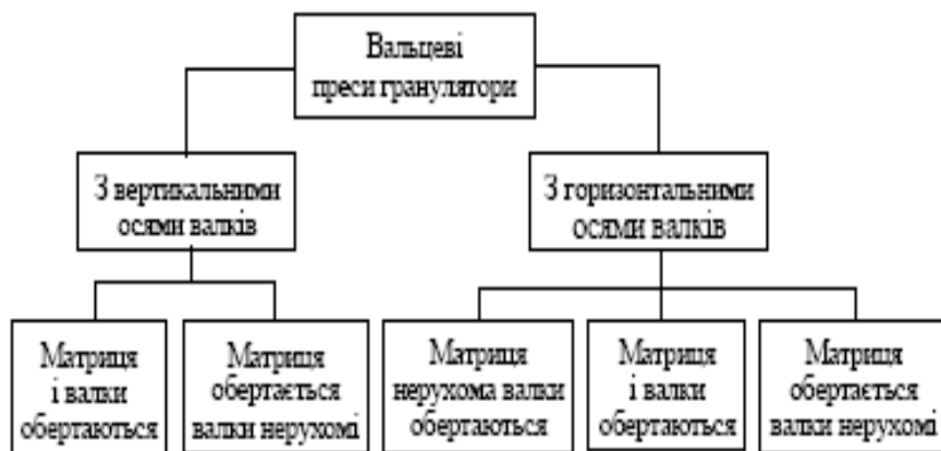
Рисунок 1 – Класифікація вальцевих пресів грануляторів
