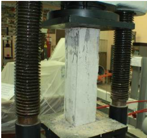
Рис. 1.5. Характер руйнування бетонної призми при стиску
