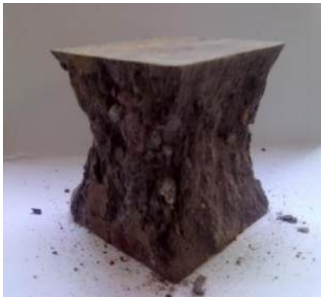
Рис. 1.4. Характер руйнування бетонного зразка при стиску Експериментально встановлено, що міцність бетону залежить від: - зернового складу (його підбирають так, щоб об'єм пористості в суміші заповнювачів був найменшим),
