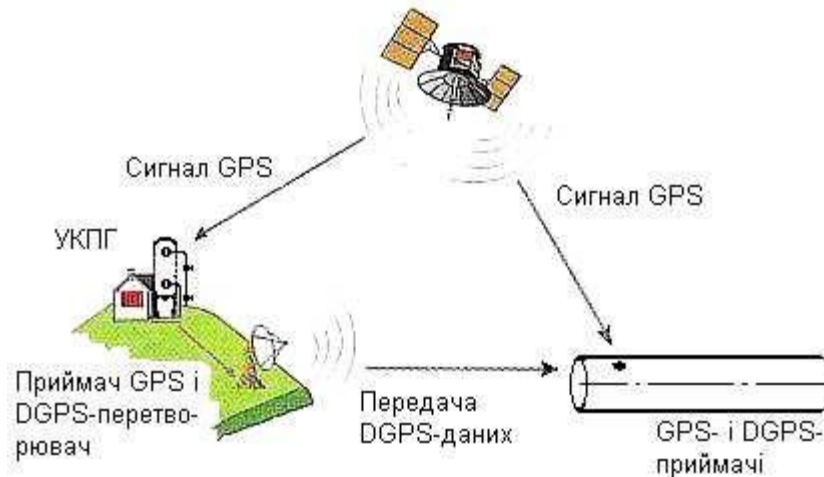
Рисунок 3. Система диференціального глобального позиціонування DGPS
