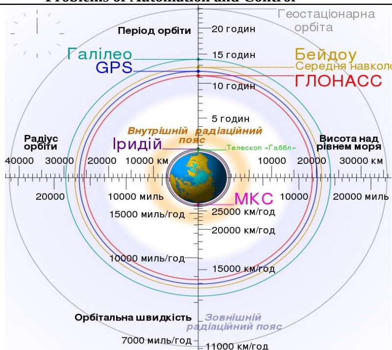
Рисунок 2. Образне зображення основних найвідоміших систем навігації та узагальнений принцип їх роботи
