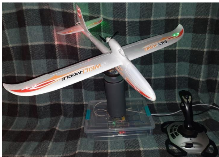
Рис. 3. Фото програмно-апаратного комплексу для вивчення процесів керування планером
