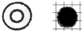
Рисунок 7.7 – Відображення втрати синхронізації в каналі на діаграмі станів (ліворуч) та на оковій діаграмі (праворуч)
