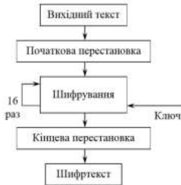
Рисунок 4.1 – Узагальнена схема шифрування в алгоритмі DES
