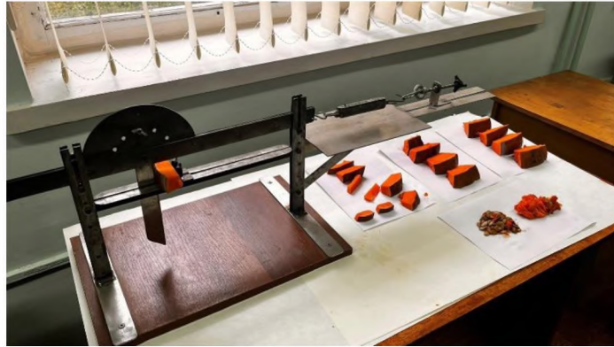
Рисунок 3.7 Лабораторне устаткування для визначення сили різання м'якоті гарбузів.
