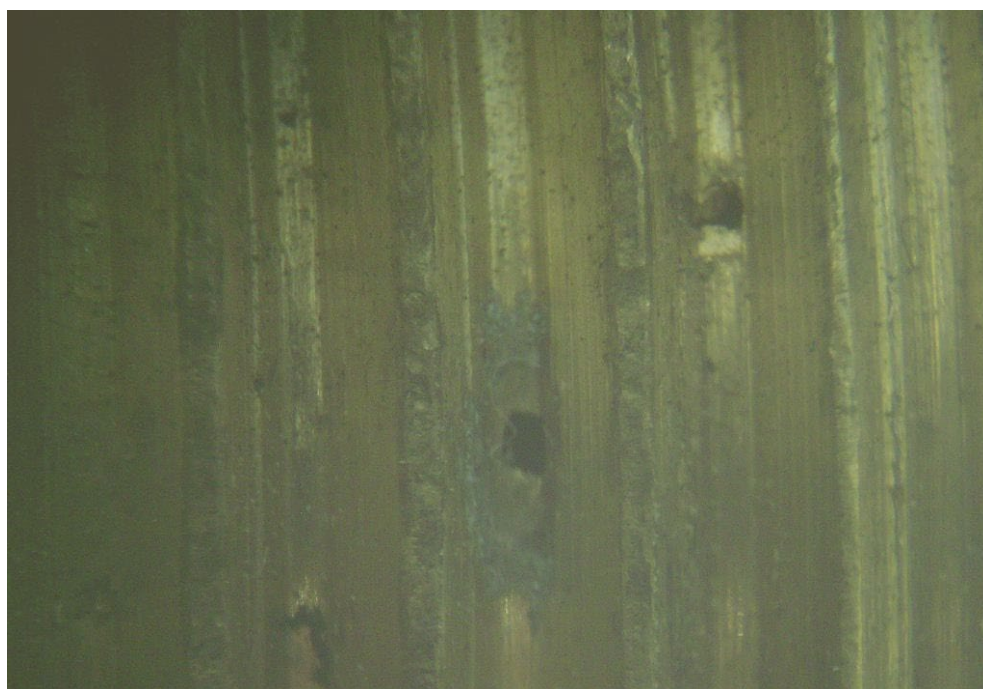
Рисунок 3.1 – Пори в сплаві ЛЦ40С . \times 120 . Нетравлено: а – поява дрібних пор; б – пори критичних розмірів
