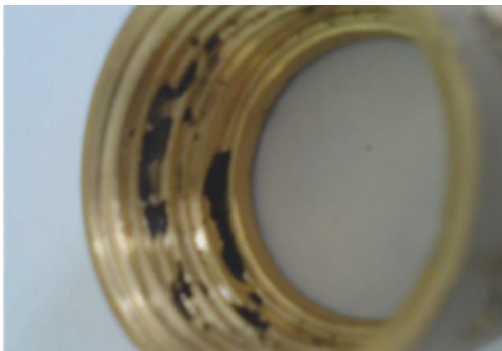
Рисунок 1.3 – Усадочні раковини, що утворилися при литті під тиском
