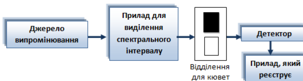
Рис. 12. Принципова схема однопроменевого приладу для вимірювання поглинання світла в УФ та видимій областях спектру.
