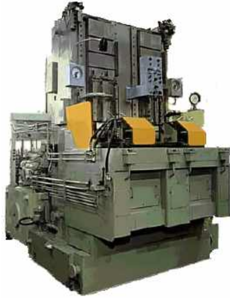
Рисунок 1.3 –. Здвоєний напівавтомат для зовнішнього протягування мод. МП7А783
