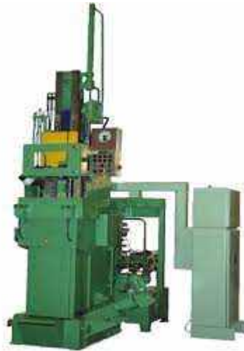
Рисунок 1.2 – Вертикальний напівавтомат для внутрішнього протягування мод. 7A623
