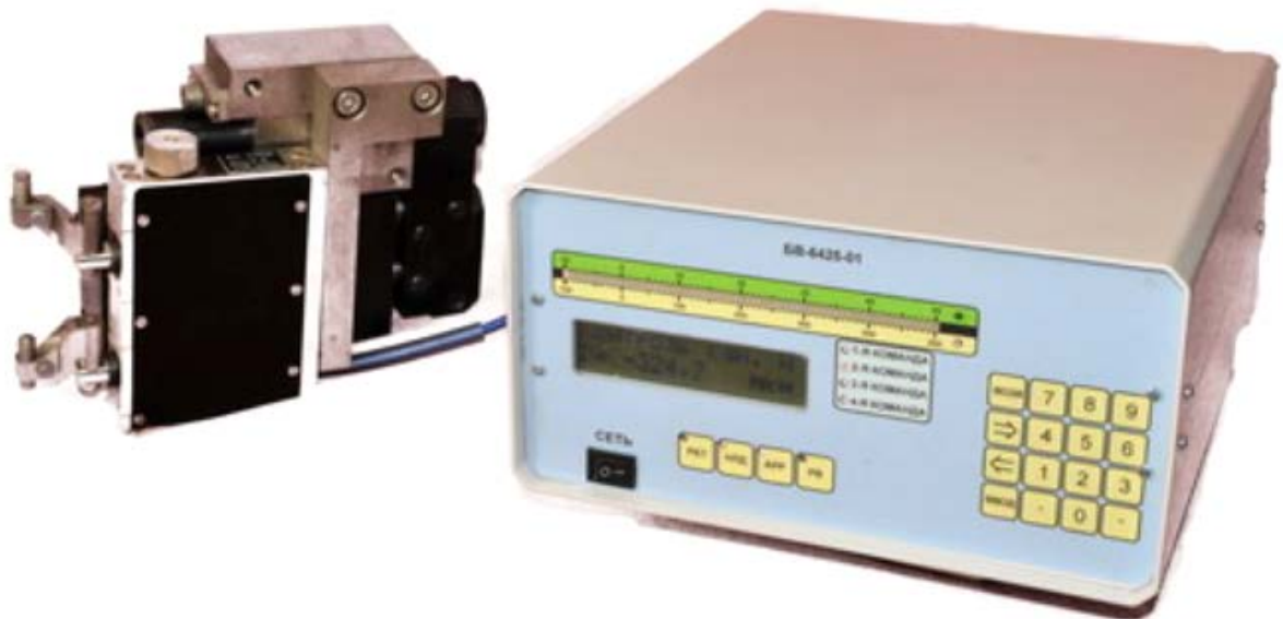
Рисунок 1.9 – Прилад для контролю деталей з переривчастою поверхнею БВ-4306 [6]
