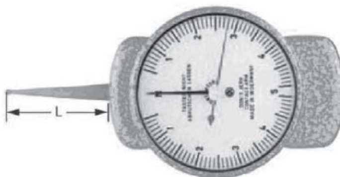
Рисунок 3.3 – Пружинний динамометр зі шкалою і стрілкою [27]
