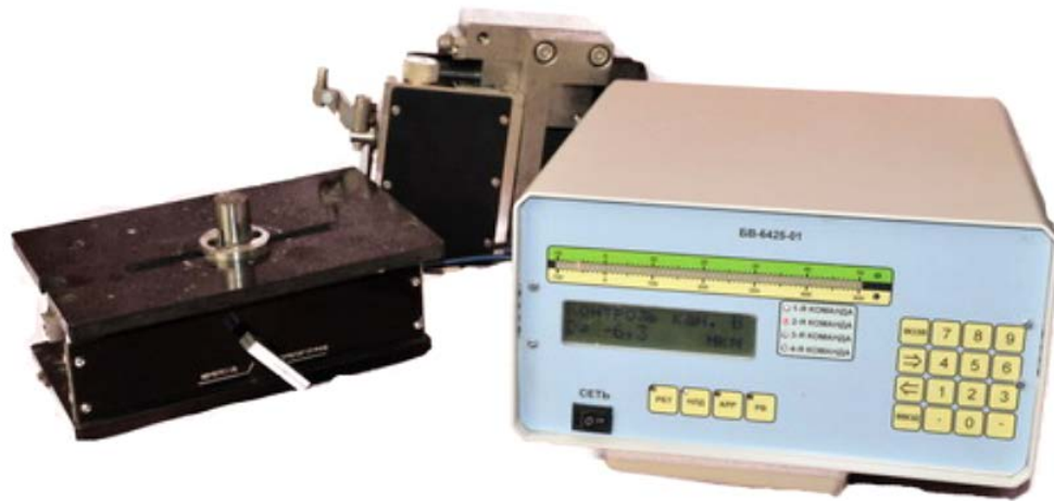
Рисунок 1.13 – Прилад для спряженого шліфування БВ-4309 [13]
