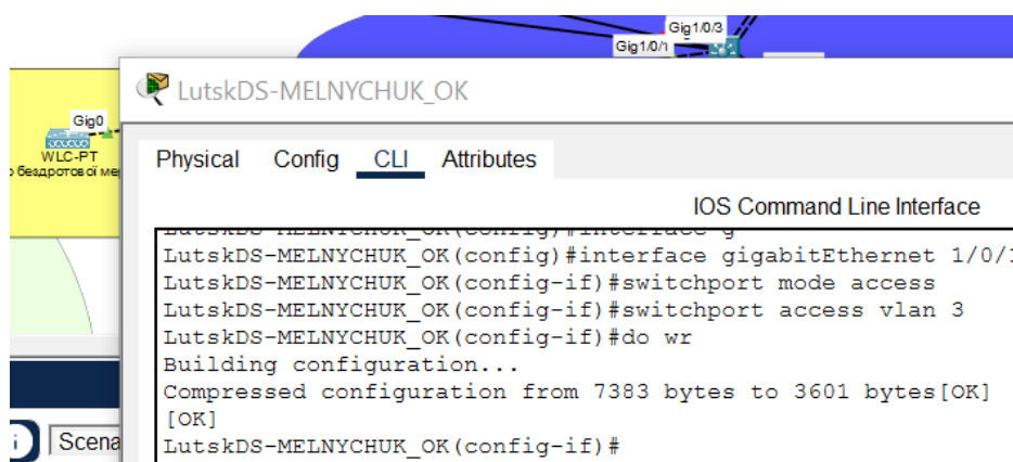
Рисунок 3.9 – Налаштування порту контролера бездротової локальної мережі до vlan 3
