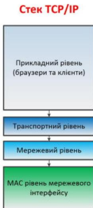
Рисунок 1.3 – Модель TCP/IP та відповідні протоколи кожного рівня [7]
