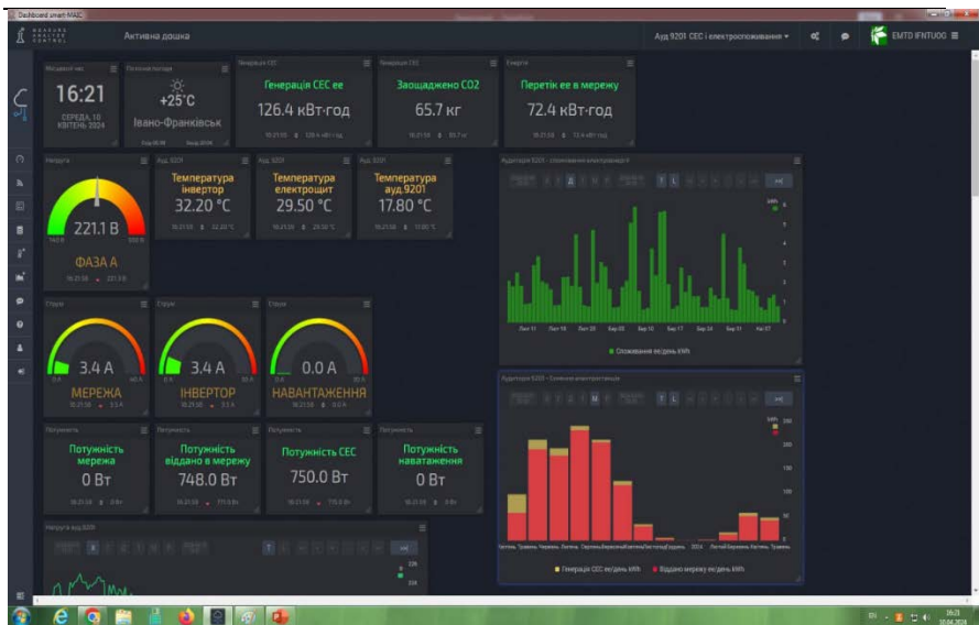
Рисунок 1 – Приклад інформаційної панелі системи моніторингу однофазної мережевої ФЕС на базі пристроїв smart-MAIC
