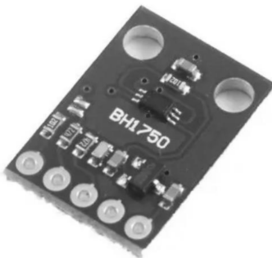
Рисунок 2.2 – Датчик освітленості на чіпі BH1750 [21]
