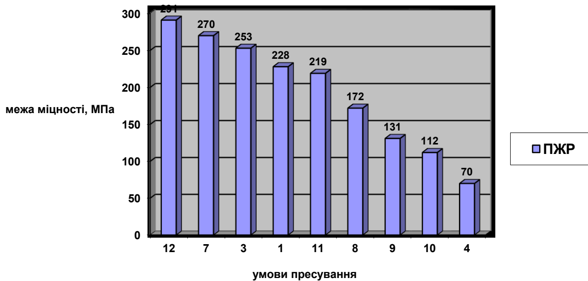
Рисунок 4.14 – Діаграма міцності залізних зразків
