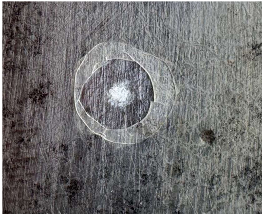
Рисунок 3.6 – Характер руйнування епоксиполімерного покриття з вмістом термопластичного модифікатора в епоксиполімерній матриці: а – 8 мас.ч.; б – 6 мас.ч.; в – 4 мас.ч.; г – 2 мас.ч.
