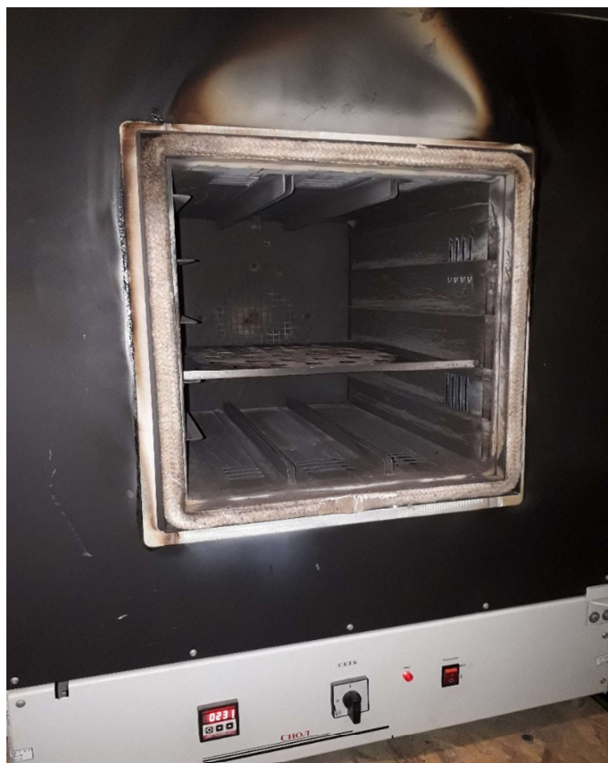
Рисунок 2.7 – Сушильна шафа моделі СНОЛ 400 з рівномірним розподілом потоків повітря
