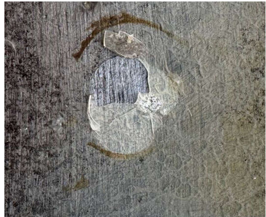
Рисунок 3.6 – Характер руйнування епоксиполімерного покриття з вмістом термопластичного модифікатора в епоксиполімерній матриці: а – 8 мас.ч.; б – 6 мас.ч.; в – 4 мас.ч.; г – 2 мас.ч.
