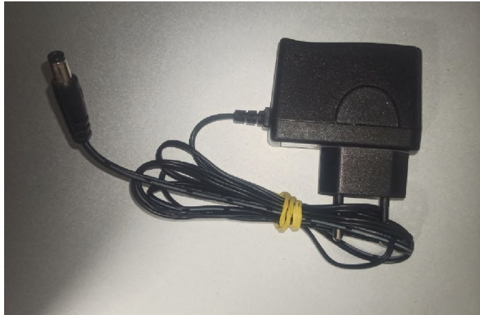
Рисунок 2.8 – Стабілізований імпульсний блок живлення 9В
