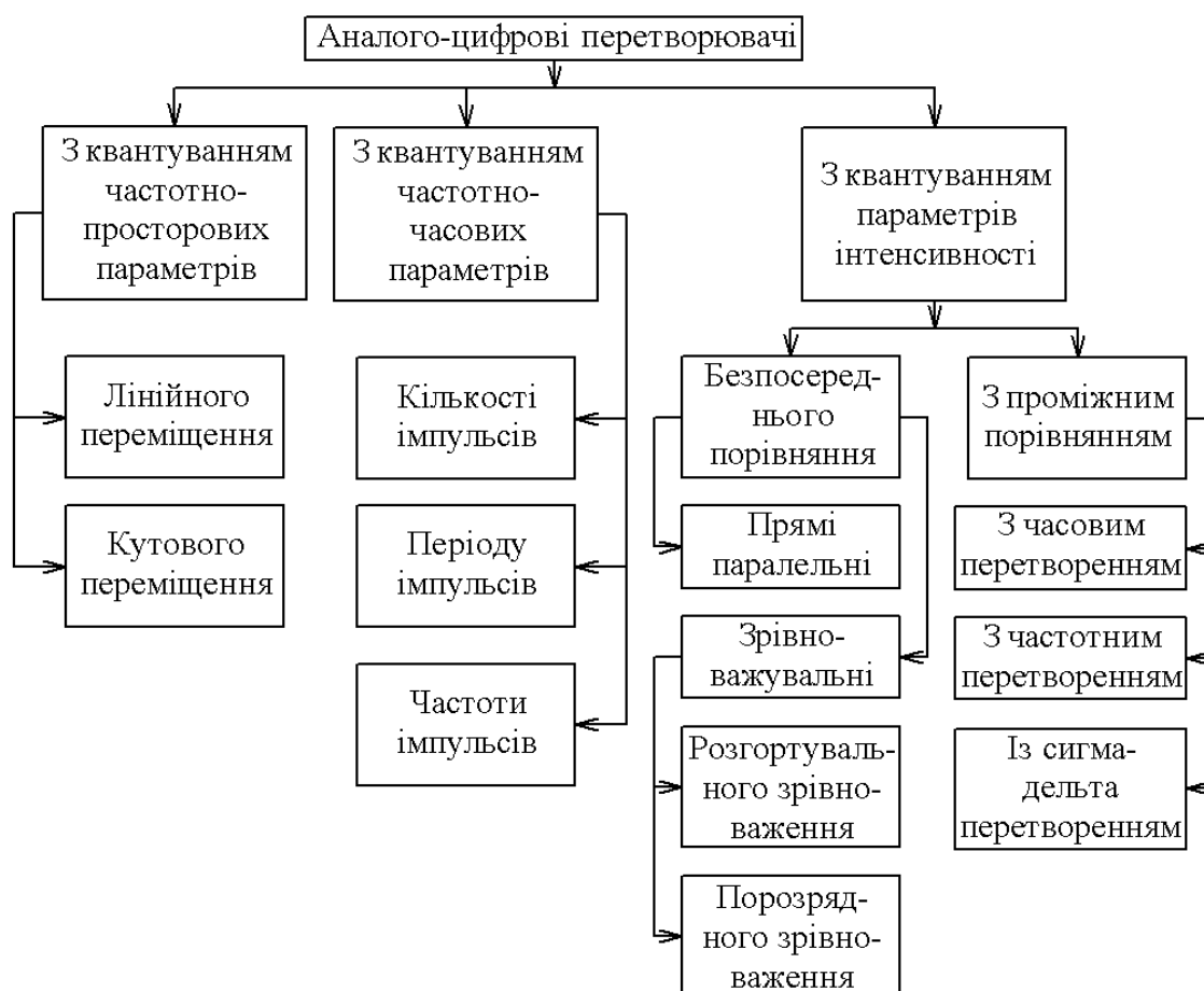
Рисунок 3.15 – Схема класифікації аналого-цифрових перетворень
